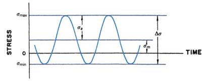
Fig. 13.3 Some useful parameters for fatigue
